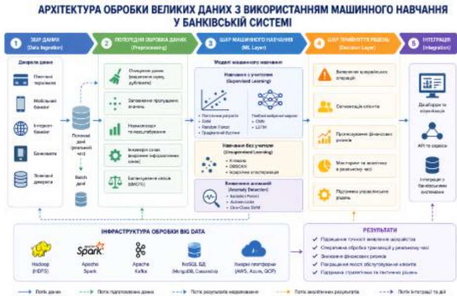
Рис. 1. Архітектура обробки великих даних із використанням машинного навчання
