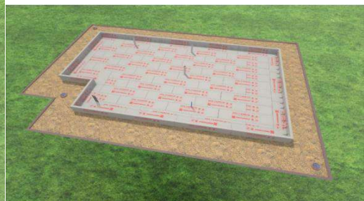
Рис. 4 Укладання другого шару плит XPS
