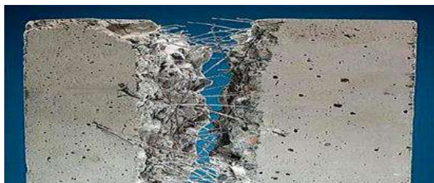
Рис. 5. Фіброволокно в бетонному блоці
