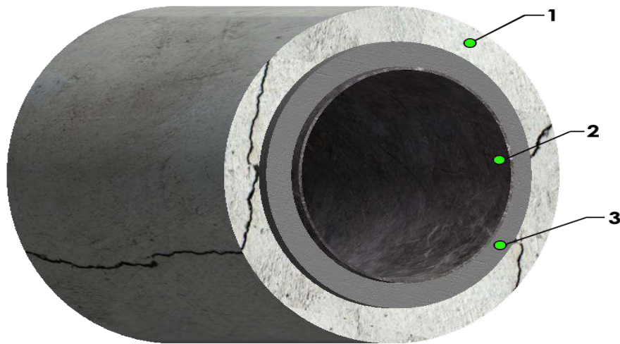
Рис. 1. Метод «гільзування» при ремонті дефектних труб:
