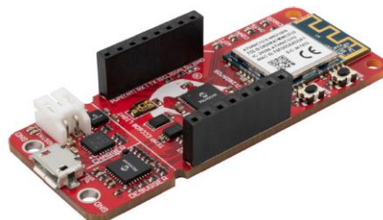
Рис. 2. Мікроконтролер PIC24FJ128GA705 з модулем WINC1510 Wi-Fi
